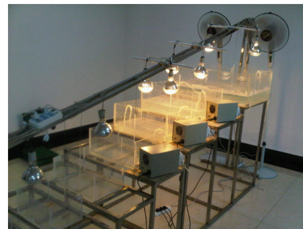
青海盐湖研究所的蒸发池模拟 (使用Rodinia公司Diablillos卤水)
